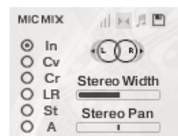
**Stereo Width**                      ステレオ・イメージの広がりコントロール。右に振り切ると、2つのパンポットを最大限にパンニングした状態と同じ。左端まで移動させると、両方のポットが中央に位置する状態と同じ。
