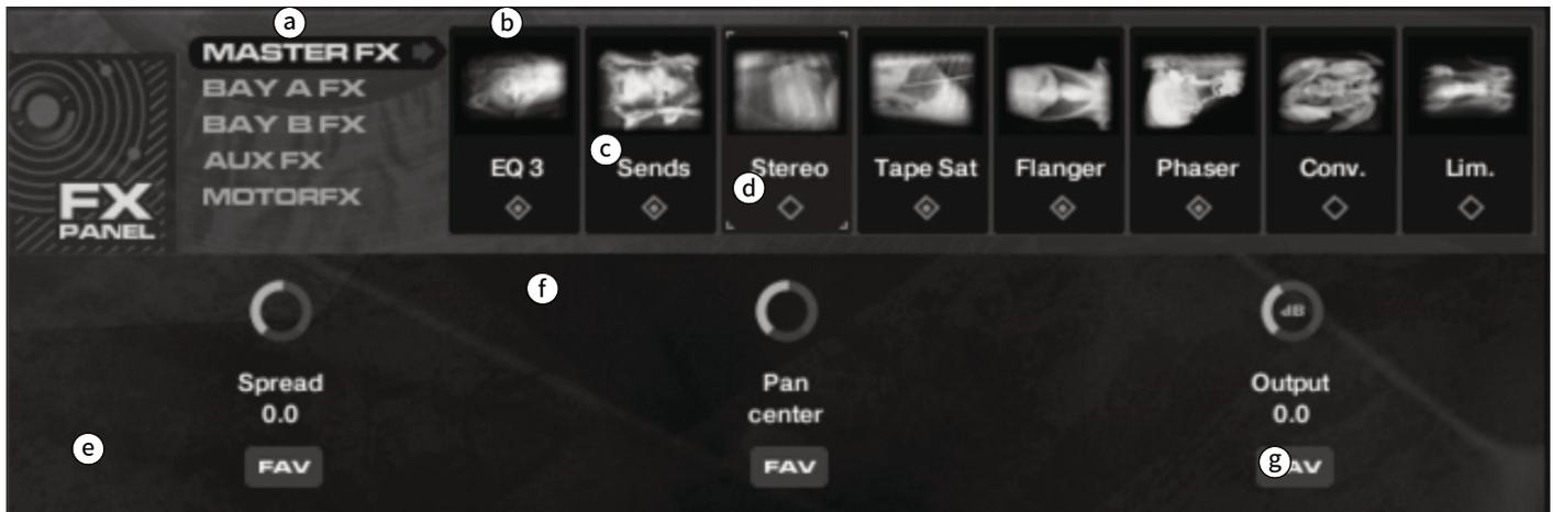
eDNAエンジンには5つのFXラックがあります。後述するMOTOR FXラックを除けば、どのラックも同じ動作をします。ここではマスター、ベイA & B、Aux FXラックの動作を説明します。
