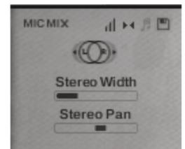
**Stereo Width**      ステレオ・イメージの広がりやディテールをコントロール。右に振り切ると、2つのパンポットを最大限にパンニングした状態と同じ。左端まで移動させると、両方のポットが中央に位置する状態と同じ。
